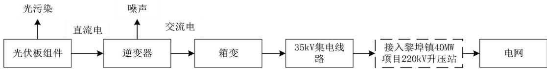
图 4-1 太阳能光伏发电流程及产污节点图
