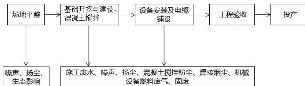
图 2-1 施工工艺流程及产污环节
