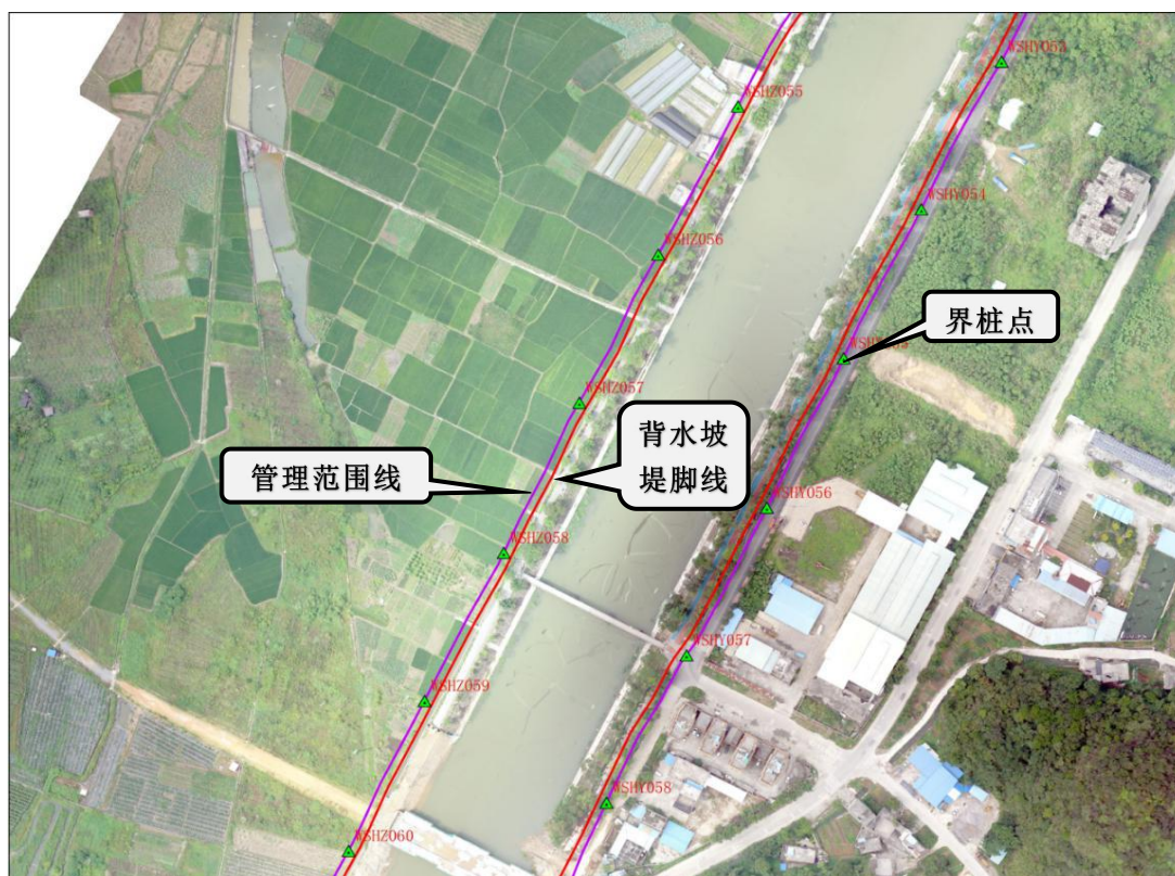
图 5-22 非城市规划区有堤河段划界成果（堤脚线 5 米外延）
