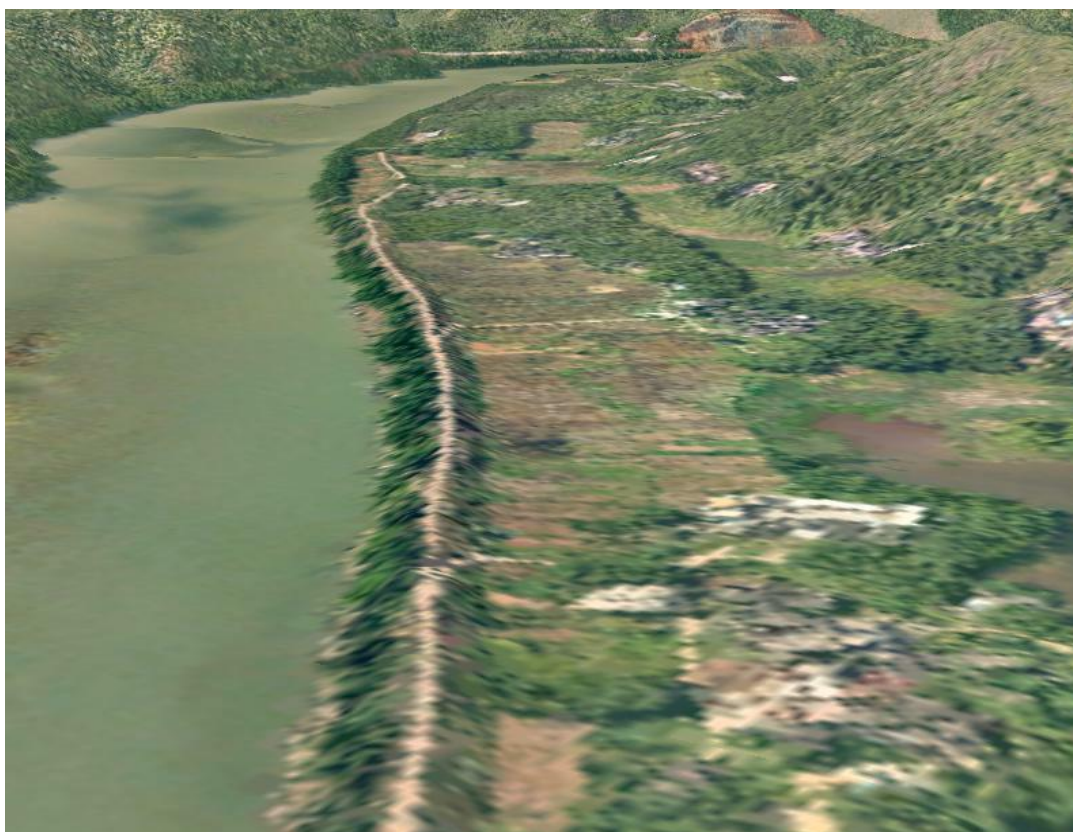
图 5-19 有堤河段生成的垂直摄影模型
