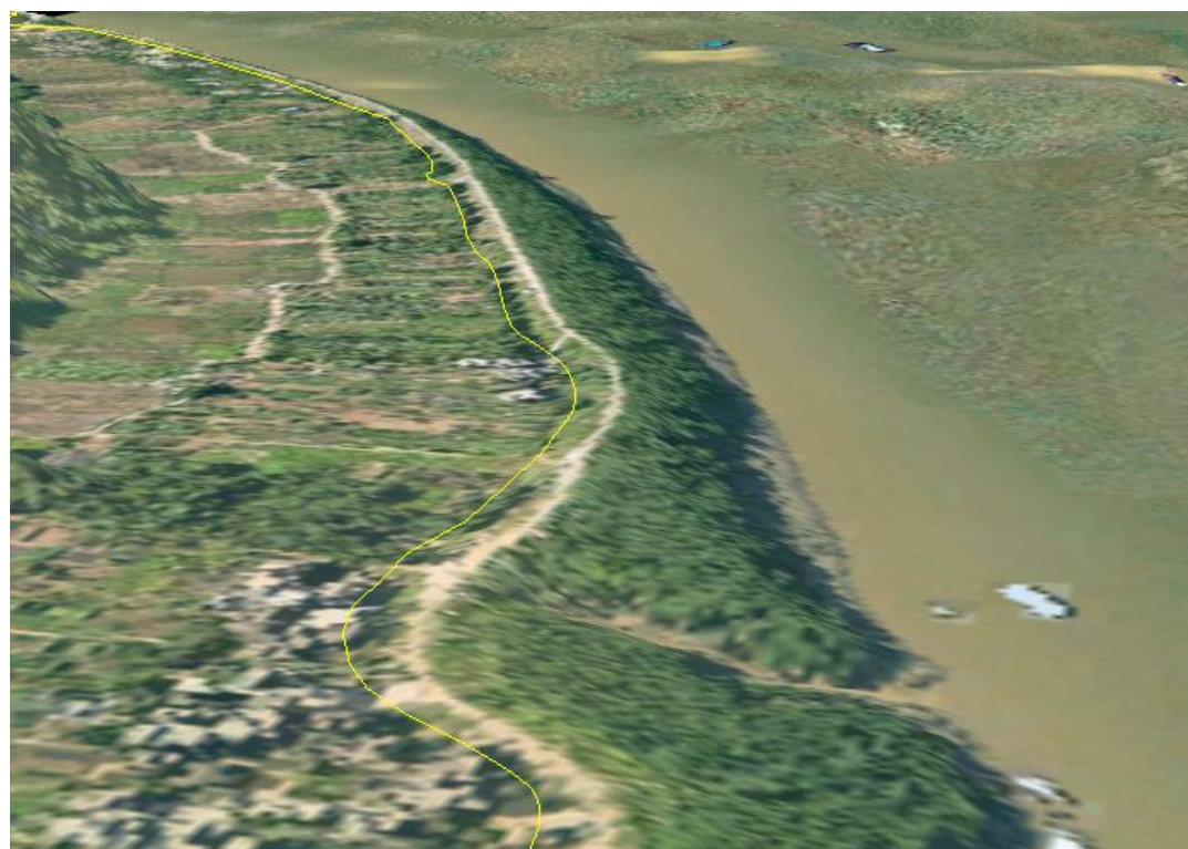
图 5-20 垂直摄影模型上勾绘堤脚线示意图
